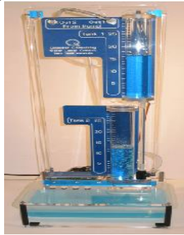
Figura 3. Configuración de tanques acoplados.
