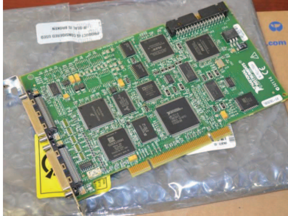
Figura 2. Tarjeta de Control de movimiento PCI-7334 de National Instruments ©.
