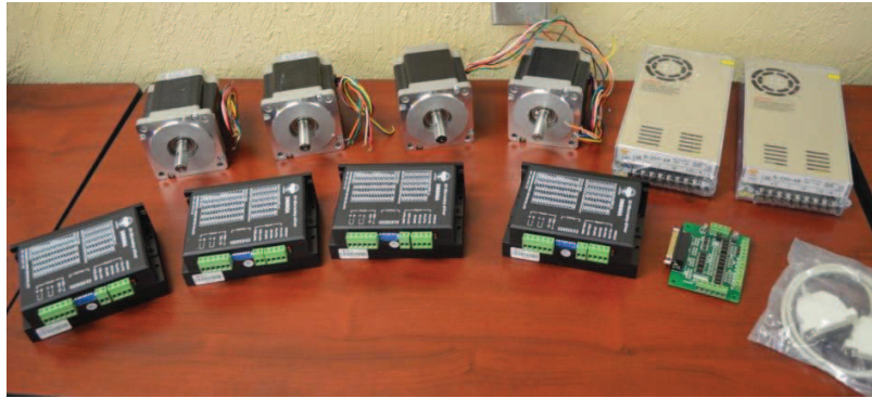
Figura 4. Motores a pasos de 2 fases, con sus respectivos controladores (drivers) y sus fuentes de voltaje.
