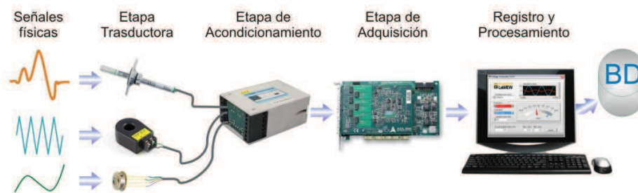
Fig. 1. Etapas principales de un Sistema de Adquisición de Datos de Estupiñan et al., 2006
